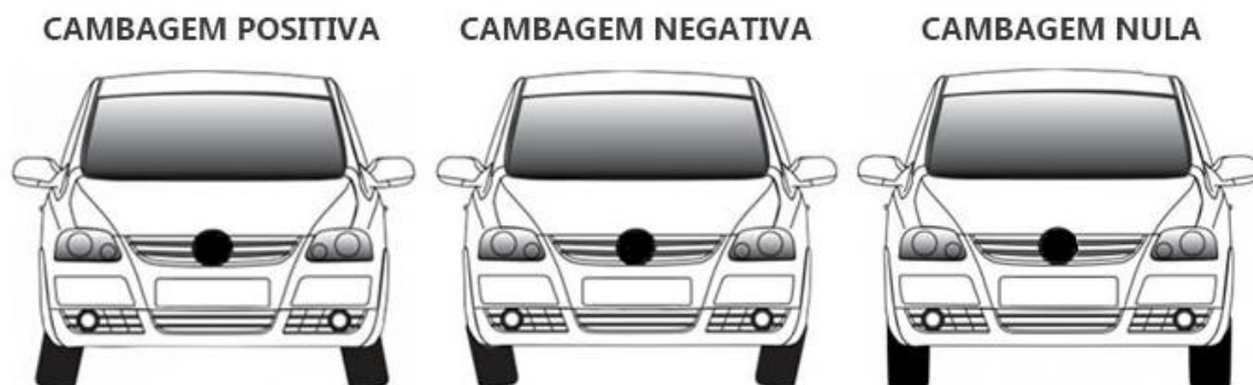
Figura 11: Representação dos tipos de ângulo de camber.
